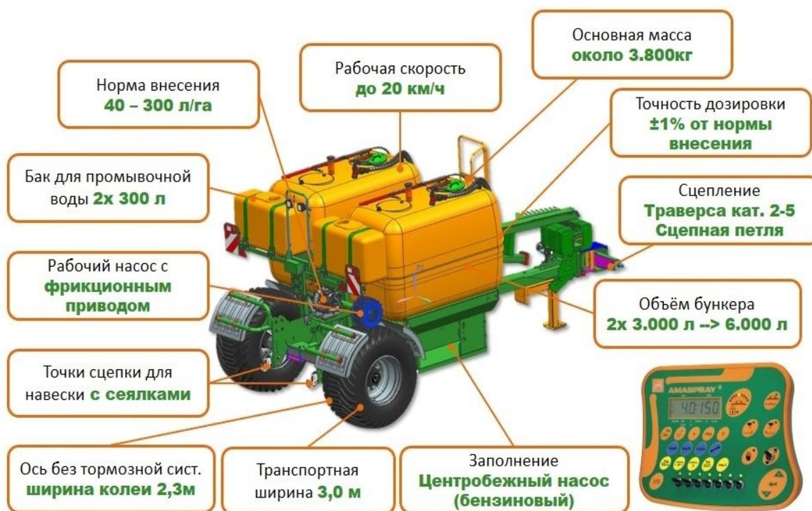
Рисунок 1. Агрегат FDC - 6000 для перевозки и подачи жидких удобрений к почвообрабатывающим и посевным агрегатам АО «Евротехника» (г.Самара)
