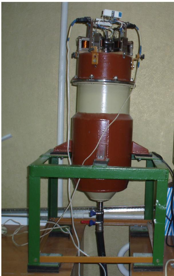
Рисунок 1. Лабораторная установка для перемешивания жидких сред с электромагнитным виброприводом
