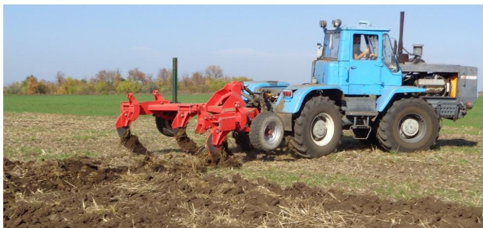
Рисунок 2. Агрегат Т-150К+ SSD–4, Terradig при обработке опытного поля
