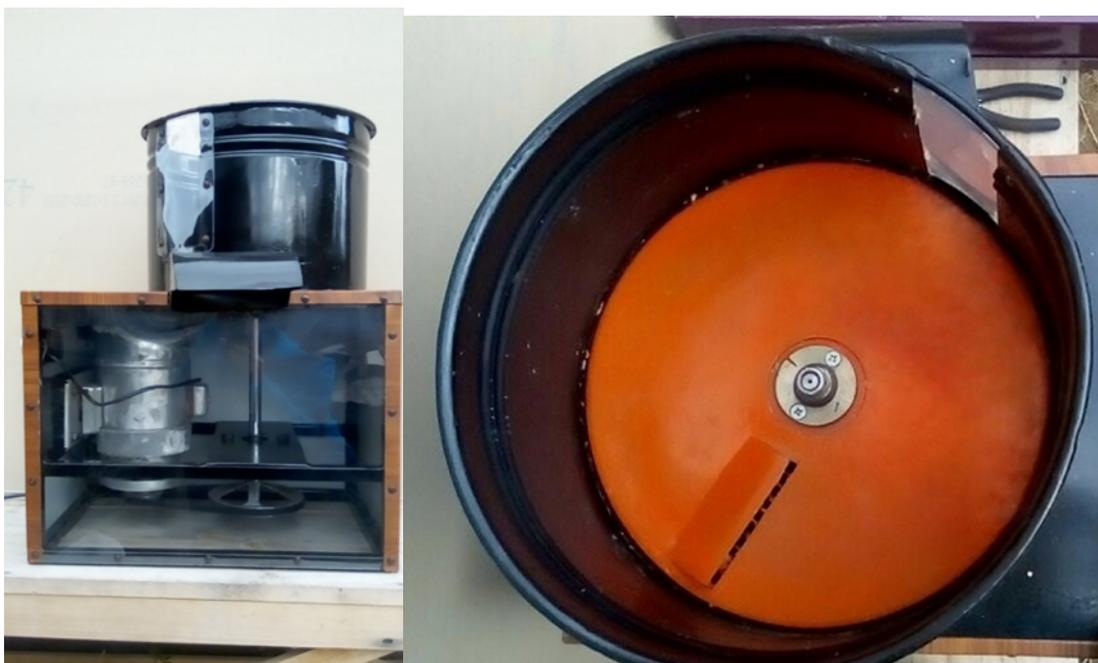
Рисунок 1. Экспериментальная установка измельчителя корнеклубнеплодов
