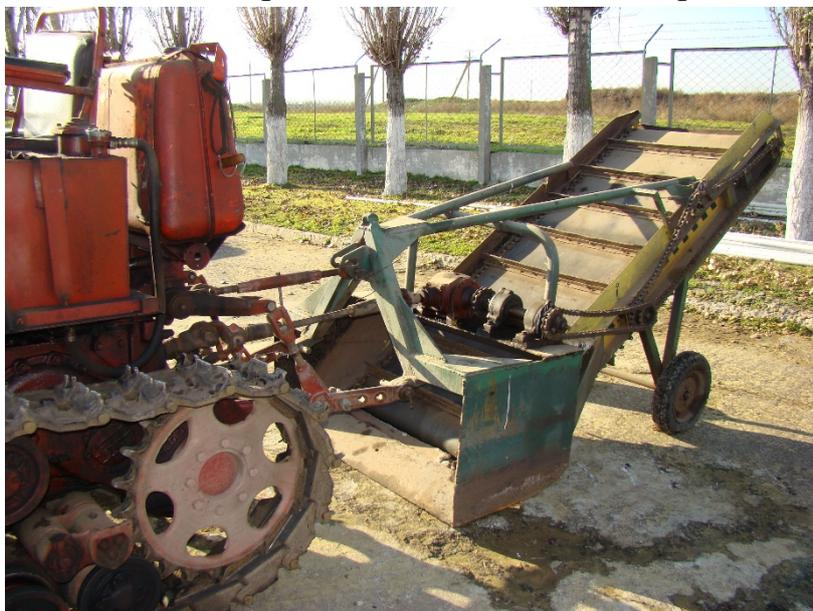
Рисунок 1 - Общий вид машины для удаления и погрузки почвы
