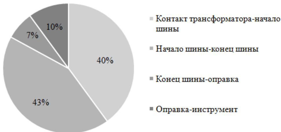
Рисунок 1. Распределение потерь электрического напряжения
