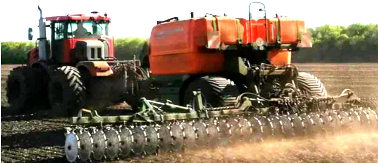
Рисунок 3. Внесение КАС опрыскивателем с крупнокапельными форсунками-а) и Эквилайзером с агрегатом FDC-6000 (АО «Евротехника», г.Самара)
