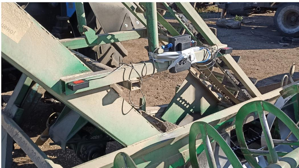
Рисунок 1. Измерительный комплекс для оптимизации режимов работы погрузчика ПЗН-250
