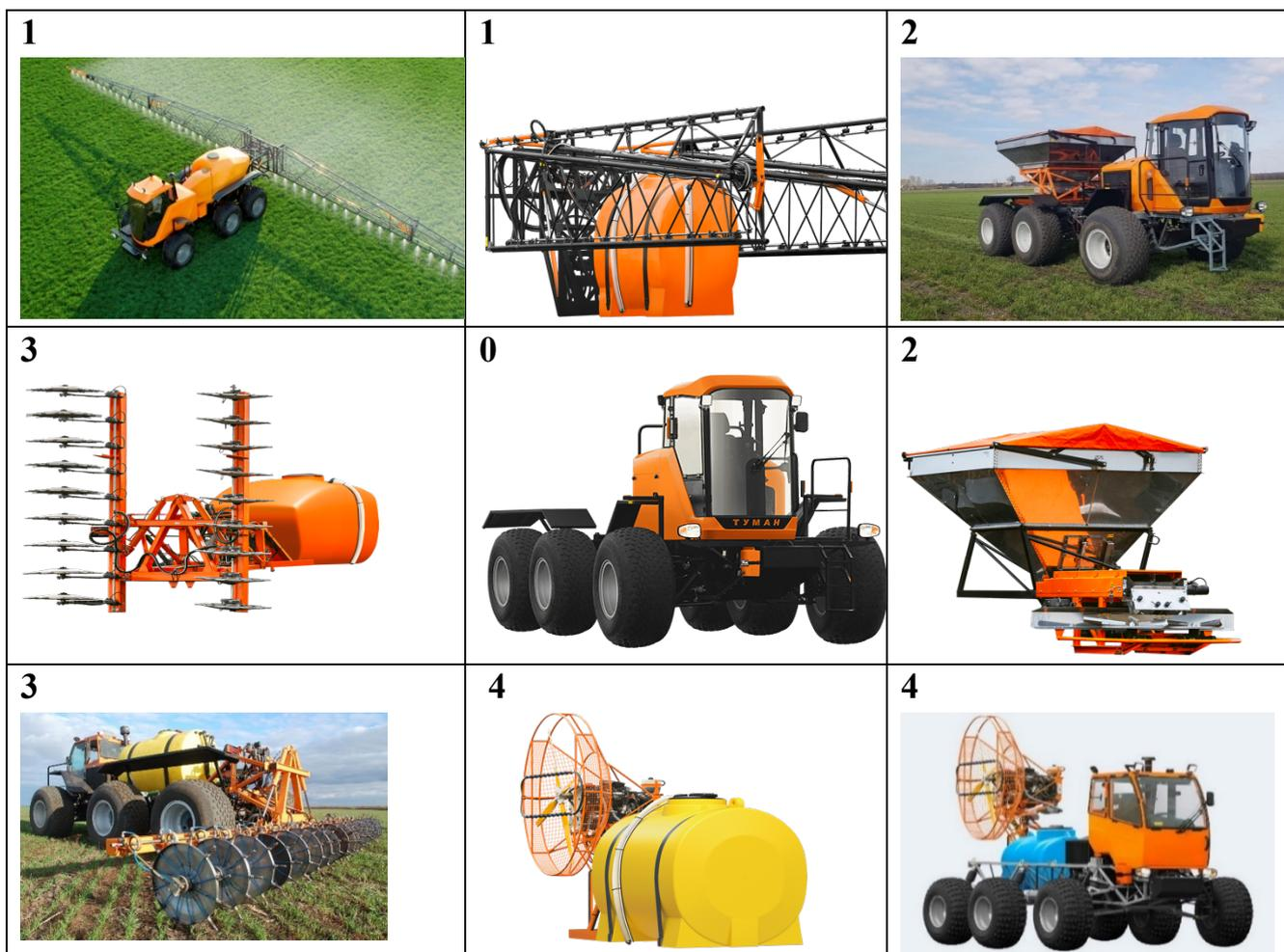
Рисунок 1. Многофункциональный комплекс «Туман»: 0-энергетический модуль; 1-штанговый опрыскиватель; 2-разбрасыватель удобрений; 3-мультиинжектор для жидких удобрений; 4-вентиляторный опрыскиватель
