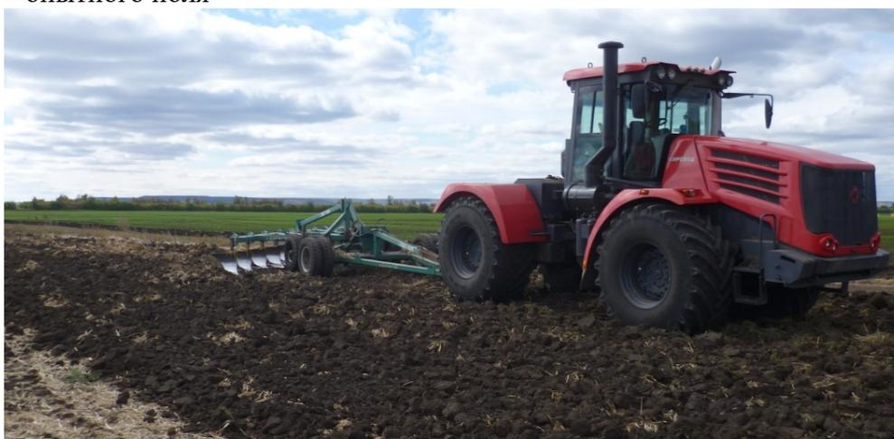
Рисунок 4. Агрегат К-9432+ПБС-10П при обработке опытного поля
