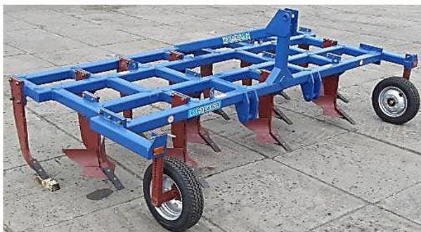
Рисунок 1. Почвообрабатывающее орудие КОМБИ-5
