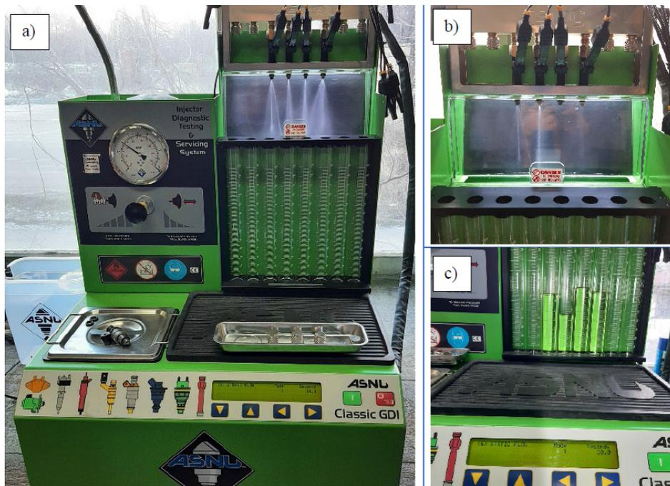
Рисунок 3 - стенд ASNU а) общий вид, б) окно контроля качества распыления с) мерные цилиндры для контроля расхода
