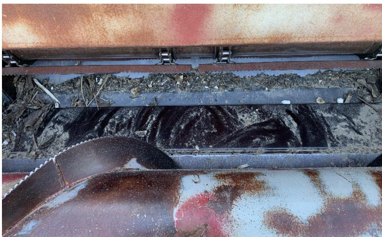
Рисунок 2. Вымолоченные маслосемена и сорные примеси в транспортёре наклонной камеры
