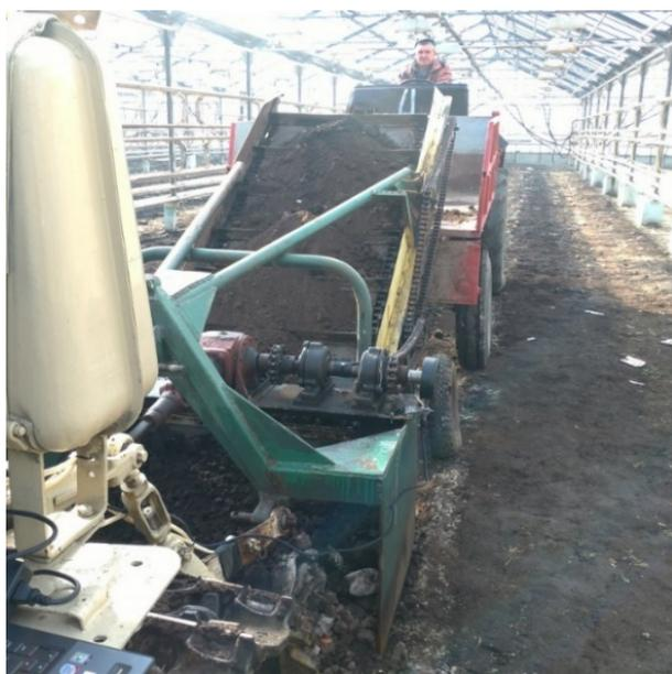
Рисунок 2 - Машина для удаления и погрузки почвы в теплицах в работе
