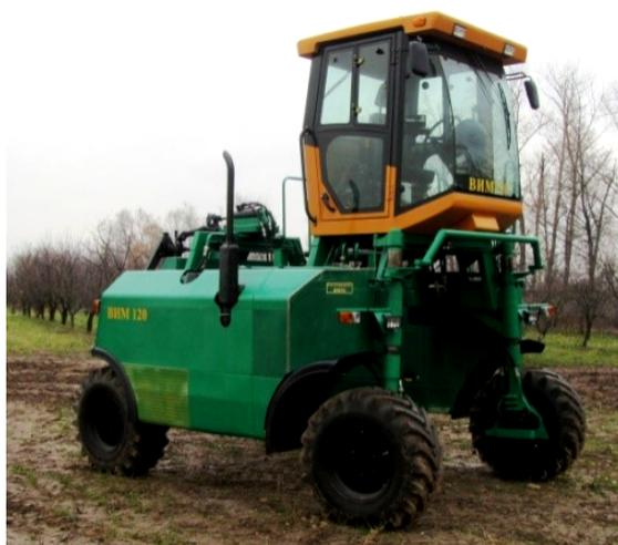
Рисунок 1. Опытный образец самоходного универсального высококлиренсного гидрофицированного энергосредства с электронным управлением (ФГБНУ ВИМ)
