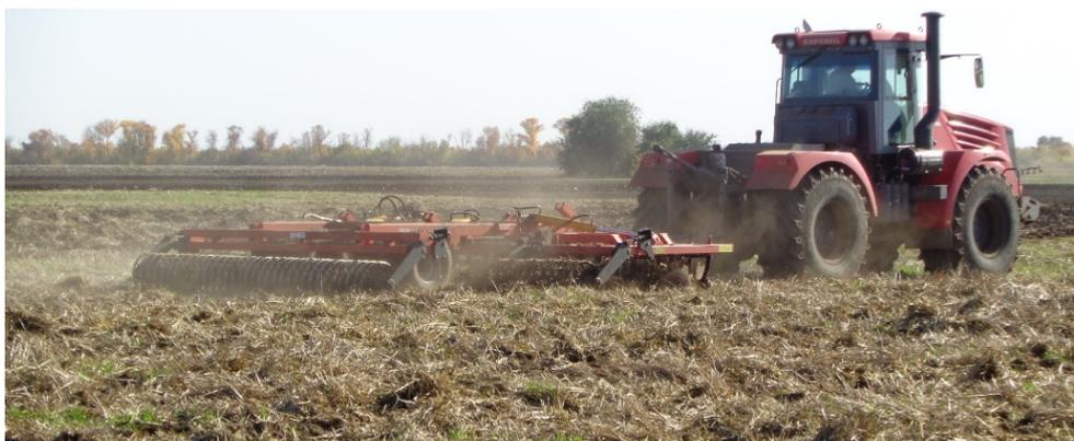
Рисунок 3. Агрегат К-9432+БДМ7х3ППКШКС при обработке опытного поля
