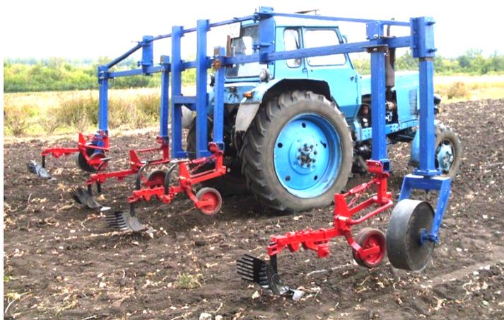
Рисунок 2. Трактор МТЗ-80 с системой обработки междурядий в питомнике с технологической полосой
