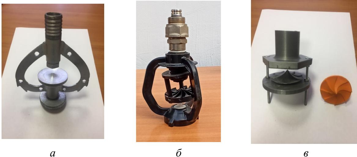
Рисунок 1. Дождевальные насадки, использованные при экспериментальных исследованиях: *а* – серийная со стационарным дефлектором с гладкой поверхностью (ГК); *б* – серийная насадка Senniger i-Wob; *в* – экспериментальная дождевальная насадка, оснащенная вращающимся дефлектором конусообразной формы с рифленой поверхностью
