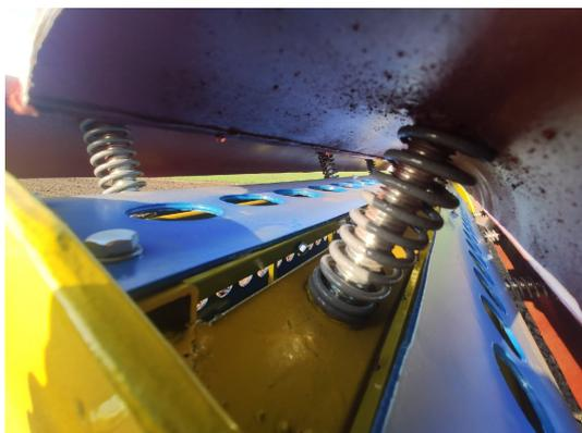
Рисунок 3 – Применение пружин в конструкции почвообрабатывающего катка
