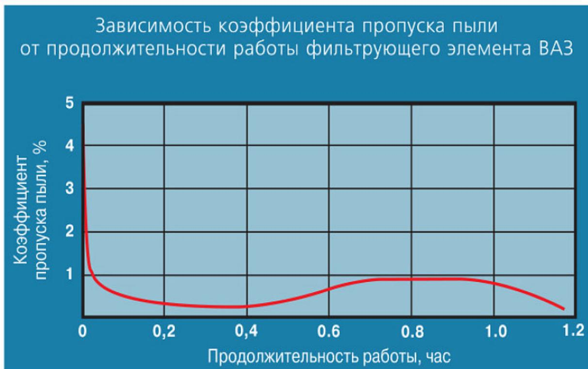
Рисунок 2. График зависимости коэффициента пропуска пыли от продолжительности работы
